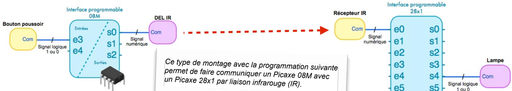
*Ce type de montage avec la programmation suivante permet de faire communiquer un Picaxe 08M avec un Picaxe 28x1 par liaison infrarouge (IR).*
