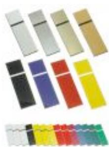
Les plaques à graver sont constituées d'un support d'une couleur sur lequel est contre-collé une fine couche d'un matériau de couleur différente. En gravant avec un outil dans la couche superficielle, la couleur de dessous apparaît, ce qui permet de dessiner ou écrire d'une couleur différente de celle du fond. L'avantage du PVC rigide et sa résistance mécanique.
