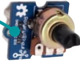
Le capteur se connecte sur l'une des entrées analogiques de A0 à A3
