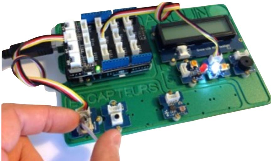
Ce programme permet d'allumer une del si le capteur est dans la première moitié de sa plage d'utilisation, c'est à dire entre 0 et 2,5 volts, soit entre 0 et 512 en numérique.
